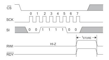
Figure 27. Software RECALL Cycle<sup>[21]</sup>
